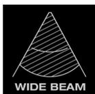
Тип распределения светового потока: широкий (WB)
